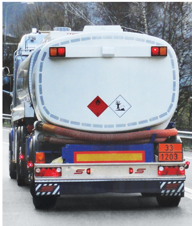
Figura 30 Autocisterna per il trasporto di benzina. Il numero 33 del codice Kemler nella parte superiore del pannello arancione indica che si tratta di una sostanza facilmente infiammabile. Il numero UN 1203 fornisce informazioni sul tipo di merce trasportata (= benzina). Il pannello raffigurante un pesce e un albero indica che si tratta di una sostanza pericolosa per l'ambiente. Il simbolo della classe di pericolo 3 sta per liquidi infiammabili.
