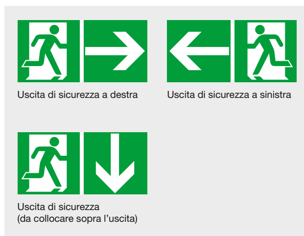
Figura 12 Segnali indicanti l'uscita di sicurezza (verdi)
