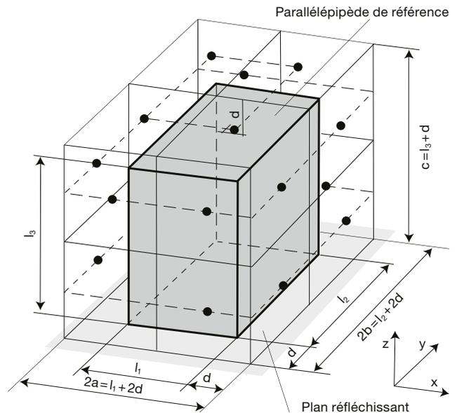
**Fig. 12** Exemple de surface de mesure et de positions des microphones pour une machine moyenne.
