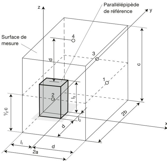
**Fig. 14** Surface de mesure parallépipédique avec quatre positions de microphones pour une source de bruit au sol et devant un mur [ $S = 2(2ac + 2ab + bc)$ ].
