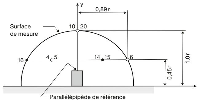
Fig.7 Position de tous les microphones sur une surface de mesure hémisphérique (coordonnées: voir tableau 5). Ici, les points 14 à 16 et 20 sont des points de mesure supplémentaires.
