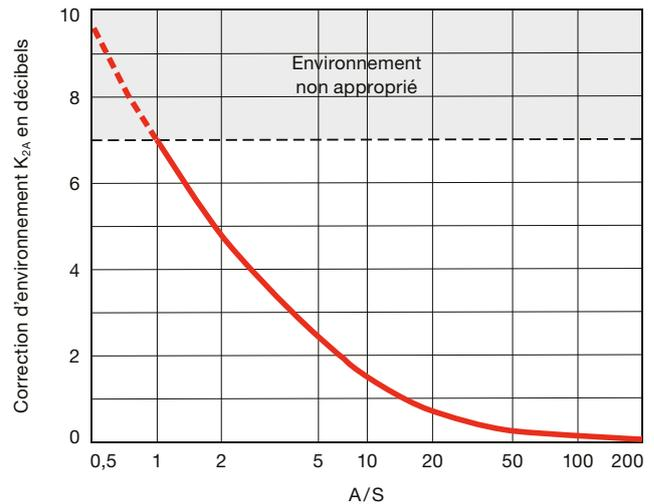
Fig. 17 Diagramme de correction d'environnement.
