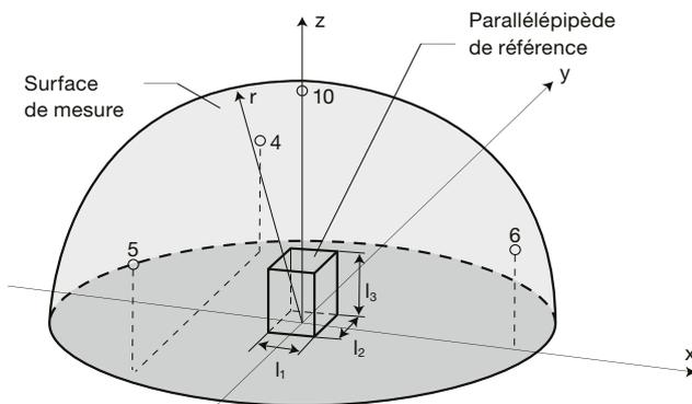
Fig.6 Positions des microphones principaux 4, 5, 6 et 10 sur une surface de mesure hémisphérique (coordonnées: voir tableau 6).
