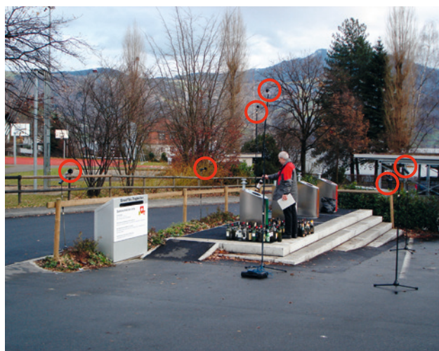
Fig. 16 Mesure du niveau de pression acoustique avec six microphones à proximité d'un poste de collecte de verre usagé. Les microphones sont signalés par des cercles rouges.
