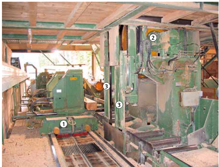
Bild 8: Tandem-Blockbandsägen mit automatisch gesteuertem Blockwagen
