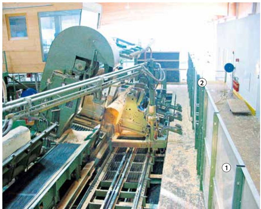
Bild 10: Blockbandsäge mit automatisch gesteuertem Blockwagen und ohne zwangsläufig gesteuerte Sägeblattverdeckung
