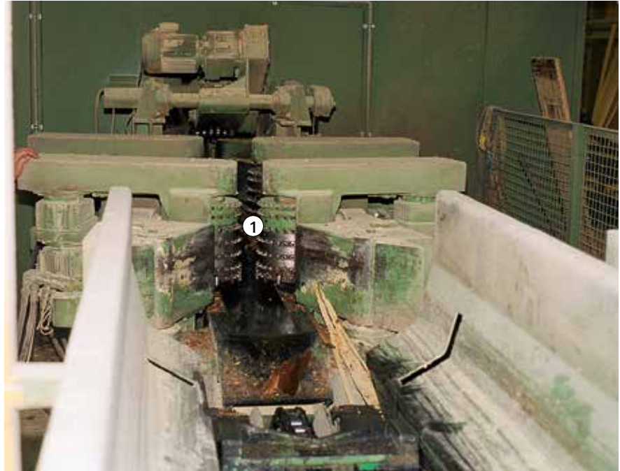
Bild 23: Geschlossenes Einzugswerk als Schutz gegen Herausschleudern von Werkstücken und Werkstückteilen
