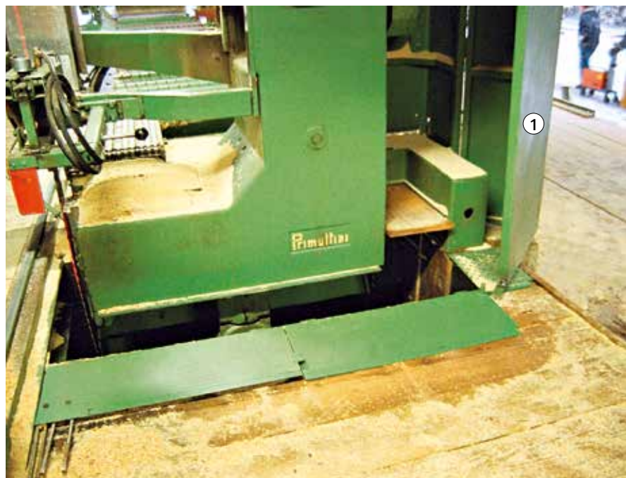
Bild 6: Grubenverdeckung der unteren Bandsägerolle – im gezeigten Beispiel kann die elektrisch verriegelte Gehäuseverkleidung erst geschlossen werden, wenn zuvor die Grubenabdeckbleche in Schutzposition gebracht wurden (ab Baujahr 1995).
