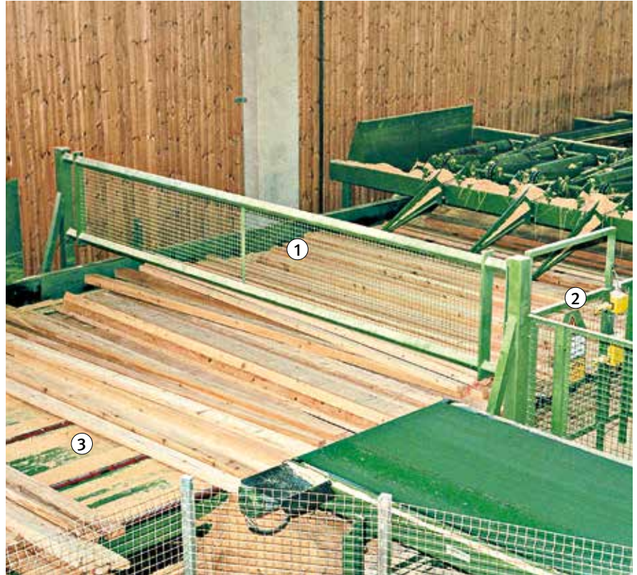
Bild 34: Ausführungsbeispiel Stetigförderer für Seitenwarenabtransport, um den Zugang zum Gefahrenbereich der Einschnittlinie zu verhindern
