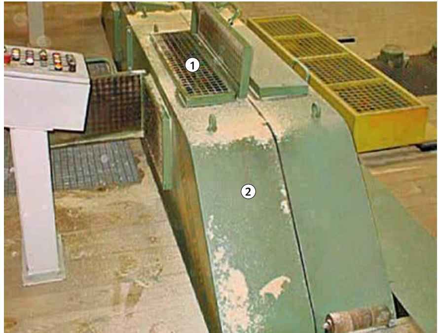
Bild 7: Sichere Einstellung des Sägeblattlaufes von einem Podest außerhalb des Gefahrbereiches
