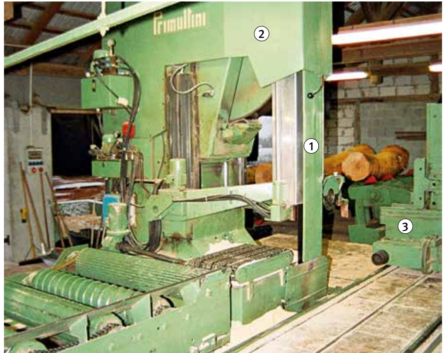
Bild 5: Blockbandsäge mit zwangsläufig gesteuerter Sägeblattverdeckung
