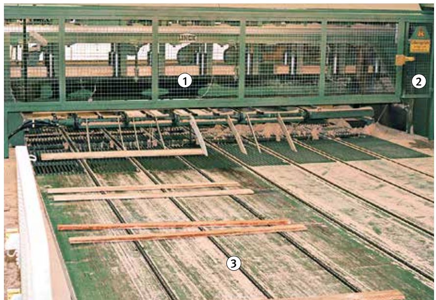
Bild 39: Ausführungsbeispiel Stetigförderer für Seitenwarenabtransport, um den Zugang zum Gefahrenbereich einer Mehrblattkreissäge zu verhindern
