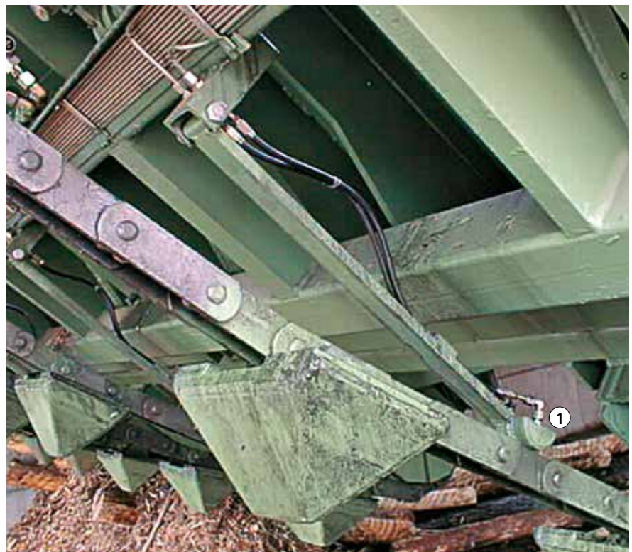
Bild 40: Zentralschmierung am rücklaufenden Kettenstrang eines Vereinzelners
