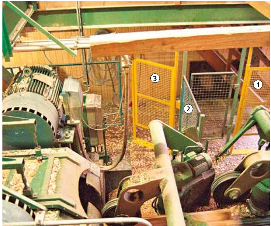
Bild 20: Einzugs- und Zentriereinrichtung mit Querabtrennung vor Parallelzerspanner
