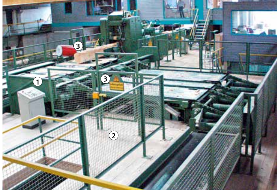
Bild 38: Ausführungsbeispiel Winkelübergabe nach Hochleistungsgatter
