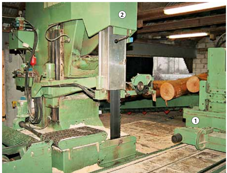
Bild 4: Blockbandsäge mit zwangsläufig gesteuerter Sägeblattverdeckung
