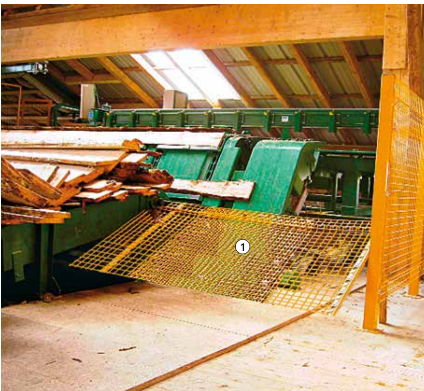
Bild 37: Ausführungsbeispiel einer abweisenden Baustahlmatte als Teil der Zugangssicherung zum Gefahrenbereich einer Vereinzellung
