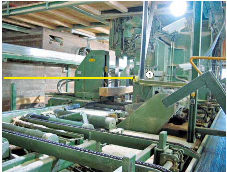
Bild 9: Blockbandsägenanlage mit Sicherheitslichtschranke ① als Zugangssicherung. Beim Unterbrechen der Sicherheitslichtschranke werden alle Vorschubbewegungen abgeschaltet und die beweglichen Sägeblattverdeckungen in Schutzstellung gefahren.
