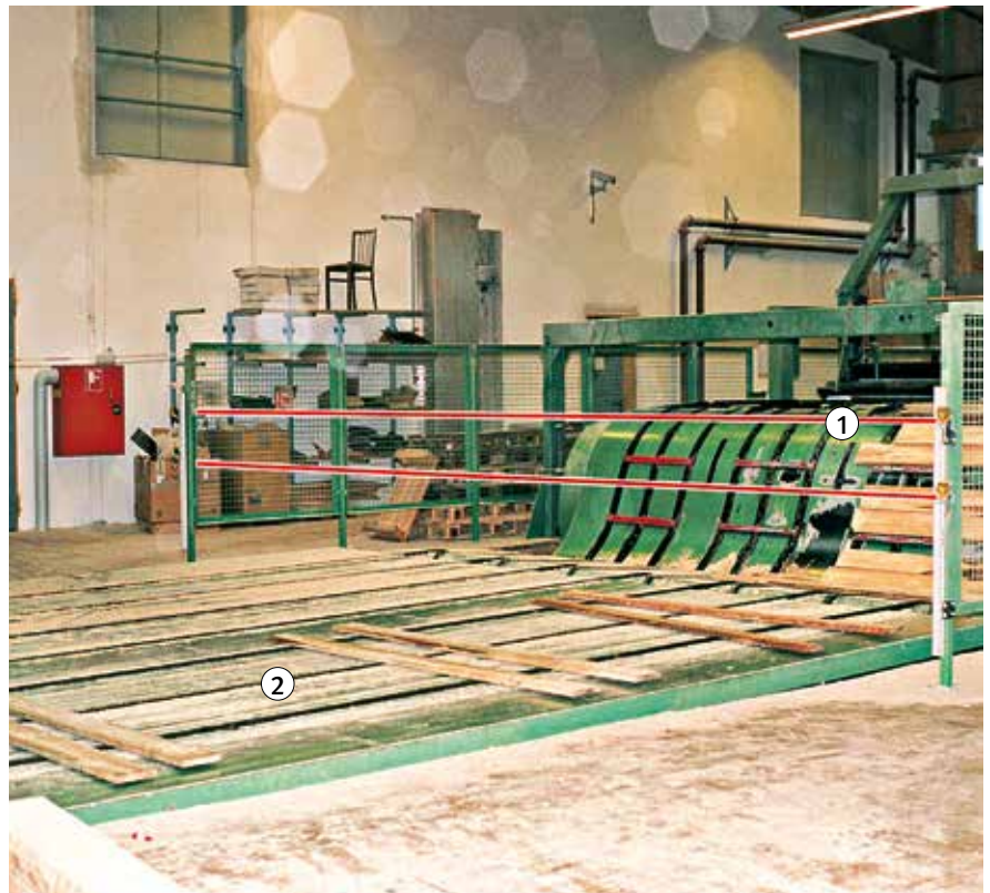
Bild 35: Ausführungsbeispiel Stetigförderer für Seitenware zwischen Einschnittlinie und Besäumanlage
