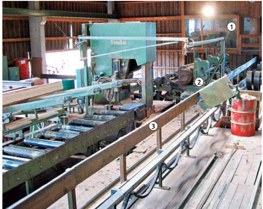
Bild 3: Blockbandsäge mit zwangsläufig gesteuerter Sägeblattverdeckung
