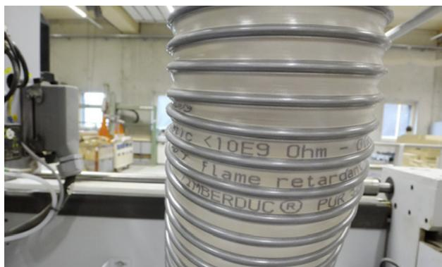
17 Tubi flessibili antistatici, difficilmente infiammabili (PUR). (fonte: von Rohr Holzbau AG)
