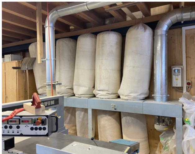
15 Estrattore di polveri vecchio con ventilatore nella parte con aria grezza (fonte: Suva).
