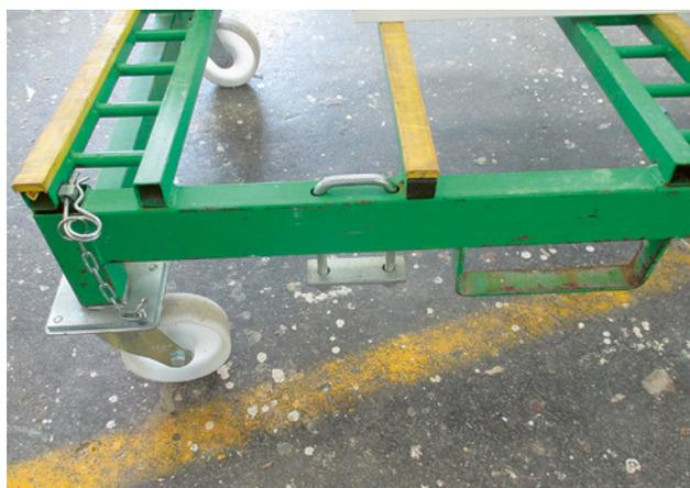
2 Châssis de transport équipés de roues démontables, points d'ancrage pour le levage à l'aide d'une grue et points d'insertion des fourches d'un chariot élévateur
