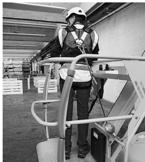
5 Quando si usa un dispositivo di trattenuta bisogna usare solo punti di ancoraggio idonei e mantenere i cordini il più possibile corti (consultare il manuale d'uso).
