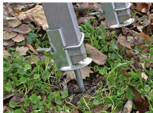
3 Su un terreno cedevole bisogna usare dei puntali in metallo per assicurare la scala.
