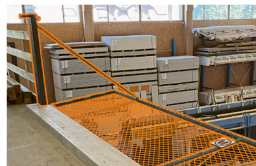
5 Übergabestelle mit ausklappbarem Fanggitter
