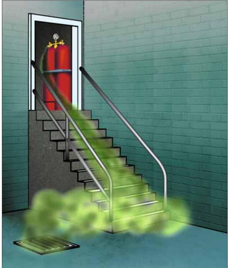
Figura 28: comportamento di un gas liquefatto [1]
