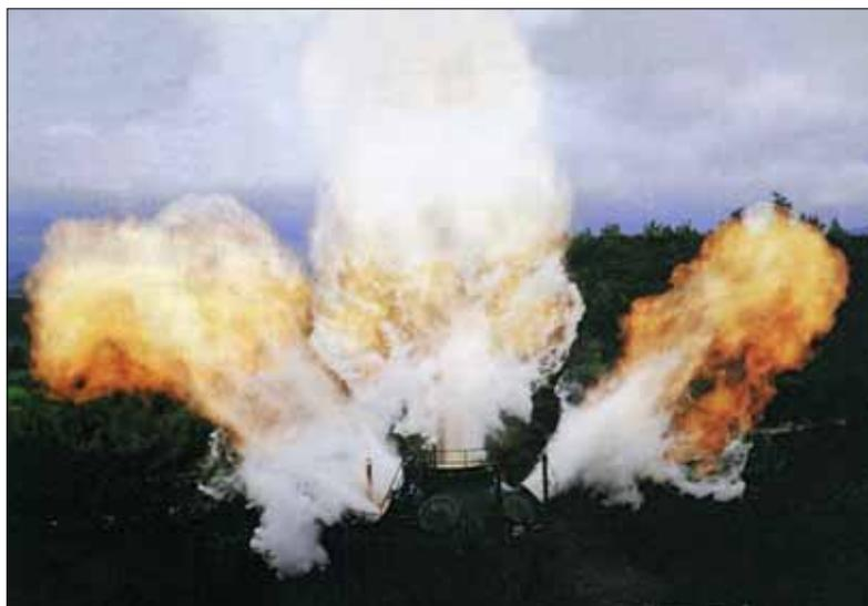
Figura 8: esplosione secondaria all'esterno del recipiente [5]
