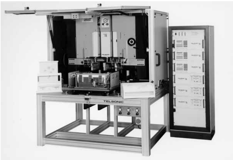
Bild 35 Sicherheitsverschaltung an einer komplexen Ultraschallschweißmaschine.
