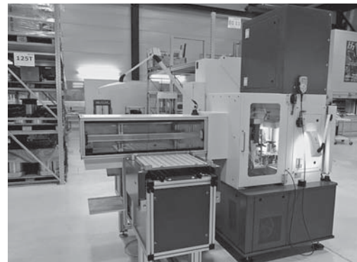
Fig. 4: tutte le zone di pericolo della pressa e dell'impianto di alimentazione devono essere messe in sicurezza correttamente.
