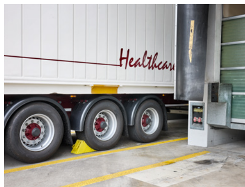
7 Befindet sich ein Keil unter dem Rad, kann das Ladepersonal sicher sein, dass der Lastwagen nicht wegrollt.
