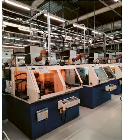
1 Décolletage-Werkstatt mit künstlicher Raumlüftung. Die Luft wird nach der Filtration wieder in den Arbeitsplatzbereich zurückgeführt.
