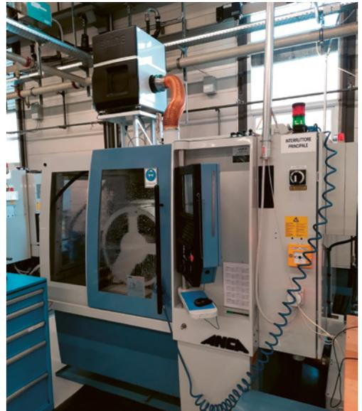
2 Einkapselte Maschine mit Absaugvorrichtung und elektrostatischem Filter.
