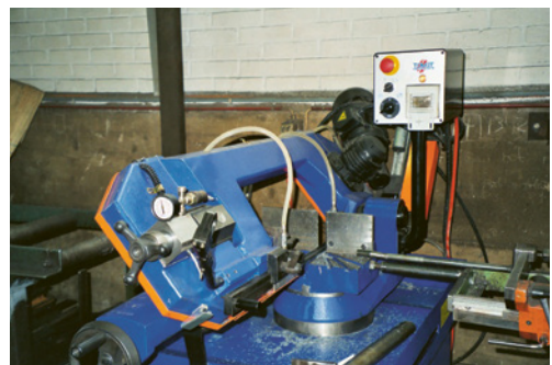
3 Lame de scie totalement recouverte jusqu'à la zone de coupe.
