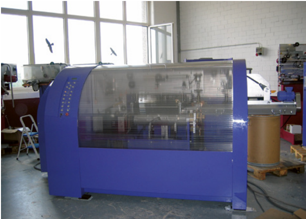
72 Incapsulaggio di un impianto per la saldatura delle lattine. Grazie alla capsula il livello sonoro sulla parete esterna si è ridotto a 82 dB(A).
