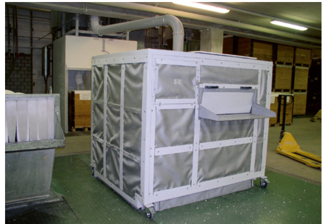
71 Incapsulaggio di un tritatore per rifiuti plastici. Riduzione del rumore: circa 12 dB(A).
