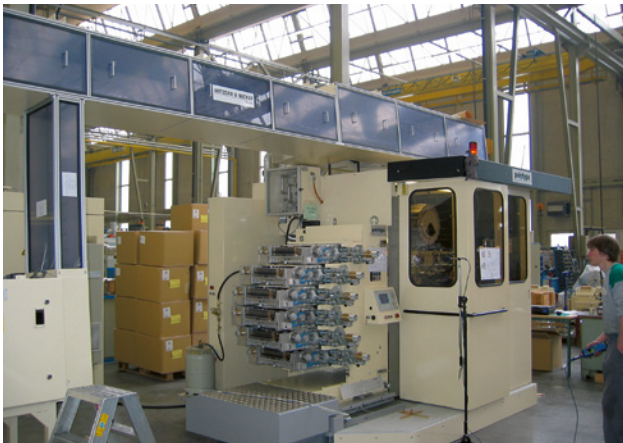
70 Incapsulaggio parziale su una macchina per la stampa di tubi (200 tubi al min.); a un metro di distanza il livello sonoro è di 77 dB(A).
