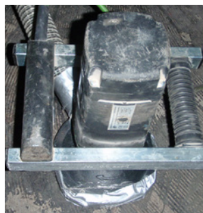
5 Ponceuse avec aspiration à la source.
