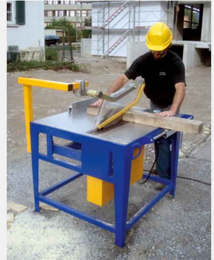
Die Schutzhaube B 90 wurde von Unfallverhütungsspezialisten der Suva und von Fachleuten der Baubranche entwickelt. Dank dieser Schutzeinrichtung, konnte die Unfallhäufigkeit an Baustellenkreissägen nachweislich massiv gesenkt werden.
