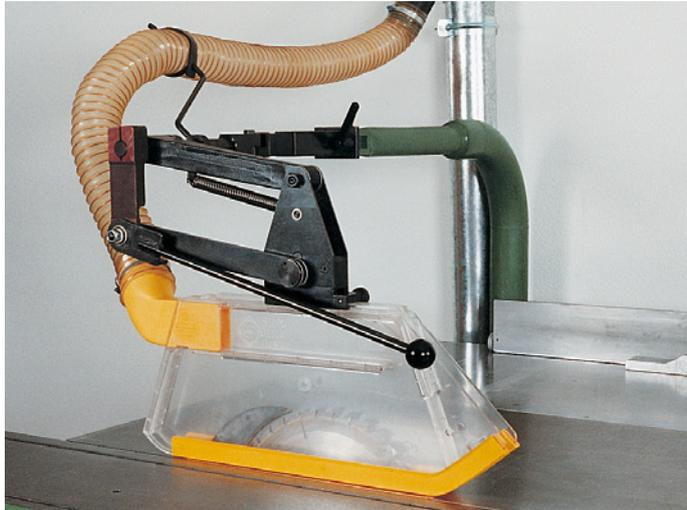
Die Schutz- und Absaughaube S 91 dient in Schreinereien als zuverlässiger Schutz der Hände vor dem laufenden Sägeblatt. Sie verdeckt das Kreissägeblatt über dem Werkstück vollständig. Mit einer Verstellvorrichtung wird die Haube parallel zum Maschinentisch angehoben. Die Haube lässt sich mit einem Schlauch von 80 mm Innendurchmesser an die Späneabsauganlage anschliessen.
