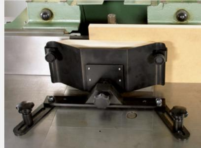
Die Seitendruckvorrichtung verdeckt das Werkzeug und drückt das Werkstück gegen den Maschinenanschlag. Für die obere Führung wird eine Führungsschiene in die Schwenkvorrichtung eingesetzt.
