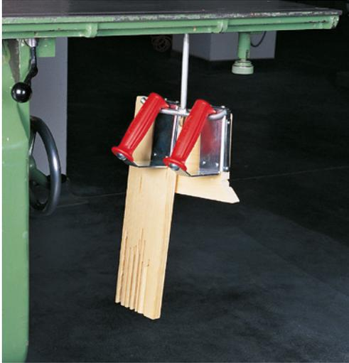
Zum Aufhängen der Schiebehölzer hat sich der Doppelhaken bestens bewährt. An ihm lassen sich zum Beispiel das Längs- und das Seitenschiebholz an einer Tischkreissäge aufhängen. Der Doppelhaken wird am Maschinenständer befestigt (Gewindegrösse M10).
