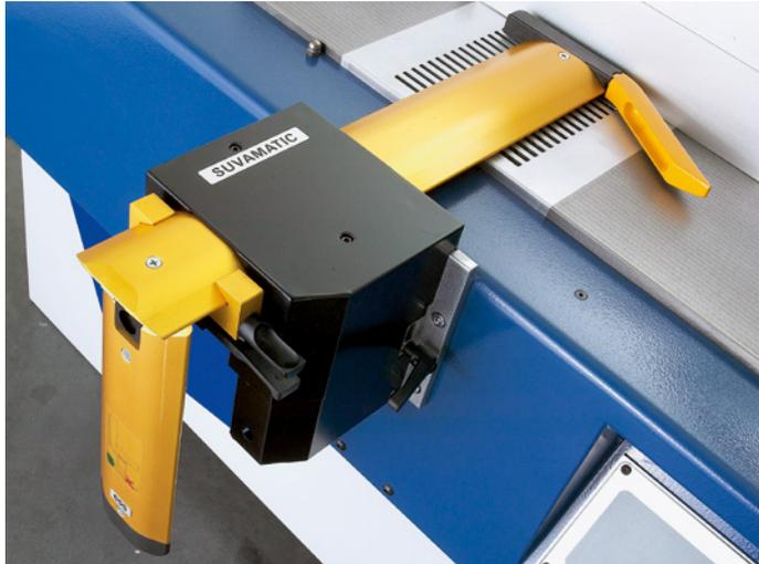
Die Suvamatic ist ein unentbehrliches Hilfsmittel beim Abrichten und Fügen von Werkstücken auf der Hobelmaschine.
