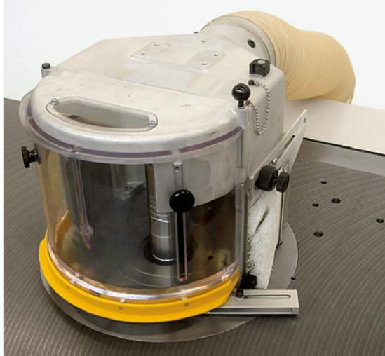
**Der Bogenfrässchutz ermöglicht das sichere und wirtschaftliche Kehlen (Fräsen) von bogenförmigen Werkstücken.**
