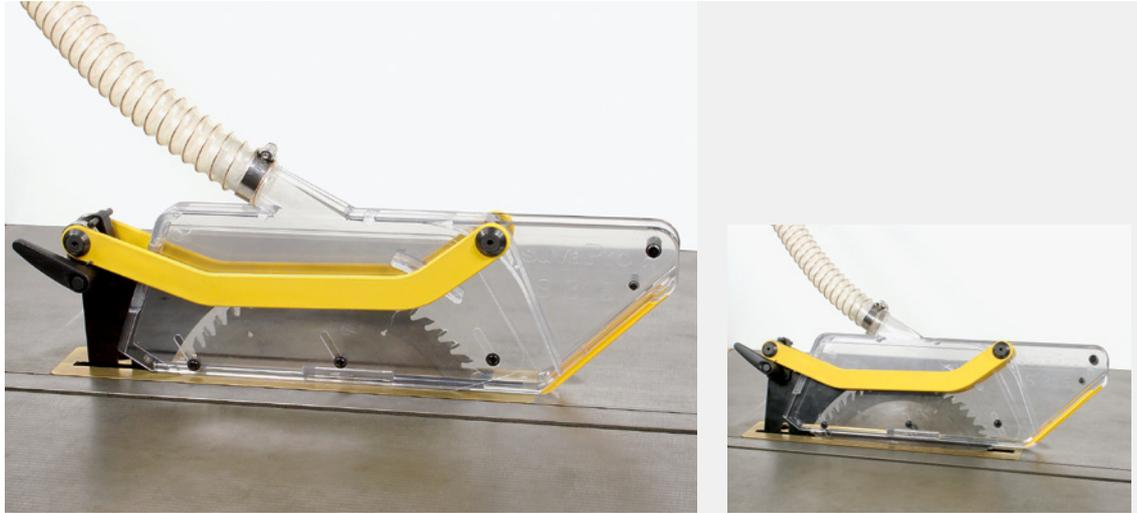
Die Schutz- und Absaughaube S 315 wird am Spaltkeil befestigt. Sie verdeckt das Kreissägeblatt über dem Werkstück vollständig. Die Haube lässt sich mit einem Schlauch von 38 mm Innendurchmesser an die Späneabsauganlage anschliessen.
