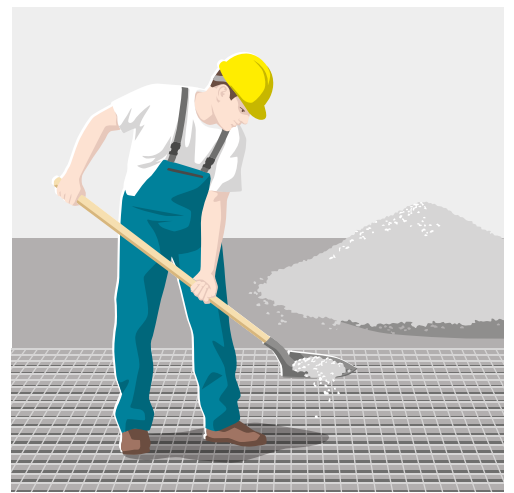
9 Beschickungsöffnung mit Rost, den das Bedienungspersonal betreten muss. Die Lücken dürfen höchstens 50x50 mm gross sein.
