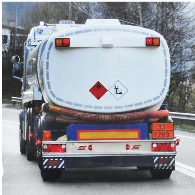
**29** Camion-citerne transportant de l'essence. Le chiffre Kemler 90 situé dans la partie supérieure du panneau orange indique qu'il s'agit d'une substance facilement inflammable. Le numéro NU 1203 permet de déterminer la marchandise transportée (= essence). Le panneau avec un poisson et un arbre signale des substances dangereuses pour l'environnement. Le losange rouge fait référence à des substances liquides inflammables.
