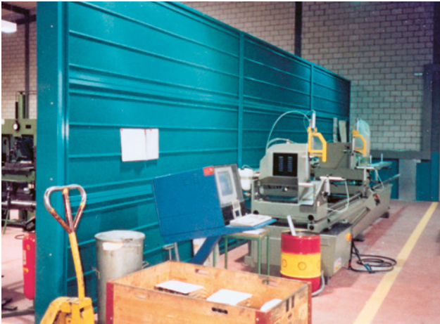
30 Cloison mobile peu efficace (plafond non absorbant).
