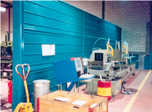
30 Cloison mobile peu efficace (plafond non absorbant).
