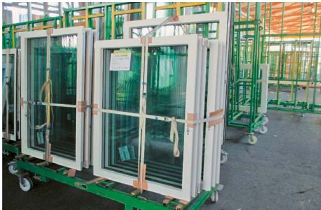
3 Le transport ne peut s'effectuer en sécurité que si les châssis de transport sont correctement chargés.
