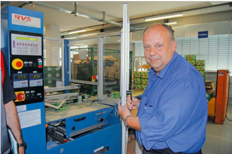
La sécurité est assurée: la machine ne peut pas fonctionner tant que la porte est ouverte.
