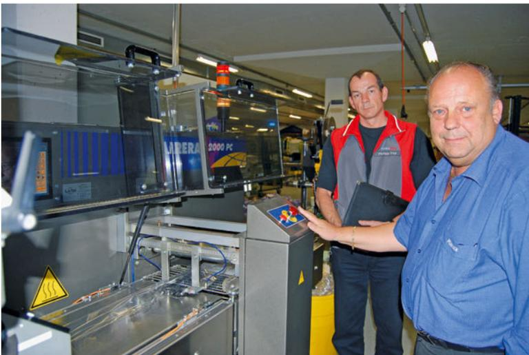
Les zones dangereuses sont équipées de capots de protection. L'ouverture d'un capot provoque l'arrêt de la machine.
