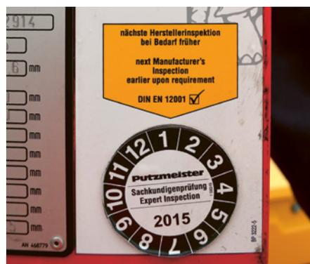
10 La date des prochains travaux de maintenance sera indiquée p. ex. sur une plaque apposée sur l'engin.
