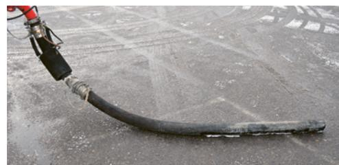
7 Flexible d'épandage sans accessoire métallique. Il est interdit d'utiliser des flexibles d'épandage munis de raccords, de manchons ou de réducteurs en métal.
