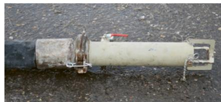
9 En cas de purge à l'air comprimé, les tuyaux doivent être équipés d'un panier collecteur.
