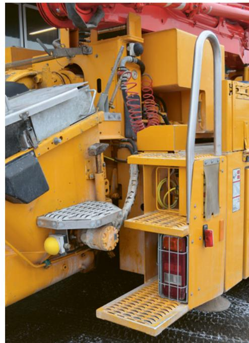
5 Les engins doivent être équipés de mains courantes et de poignées disposées de manière à permettre aux opérateurs d'accéder en toute sécurité aux postes de commande.
