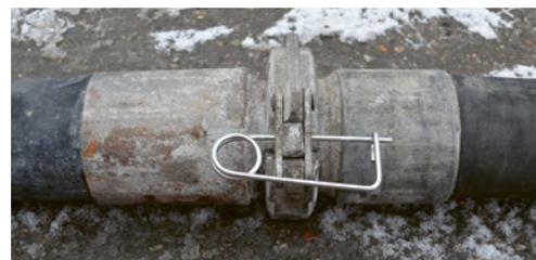
6 Les tuyaux en acier, les tuyaux d'épandage ainsi que les raccords doivent être correctement montés et protégés contre toute ouverture intempesive.
