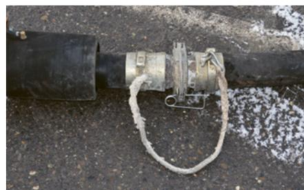
8 Corde de sécurité conforme aux spécifications du fabricant.
