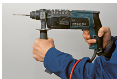
2 Perceuse à main, classe de protection 2.
