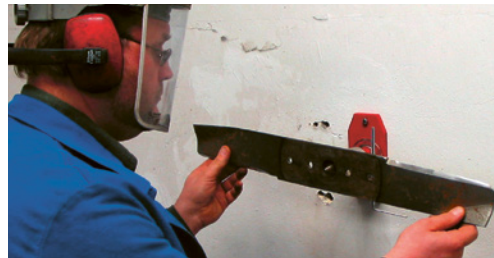
4 Cet outil permet de vérifier si la lame est bien équilibrée après avoir été aiguisée.
