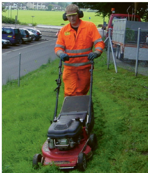
3 Il est nécessaire de respecter la distance de sécurité indiquée pour éviter de blesser des passants ou des collègues et d'abîmer des objets à proximité.
