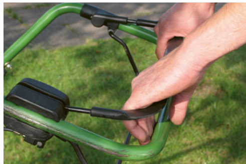
2 Les dispositifs de commutation (p. ex. à action maintenue) doivent être en parfait état de fonctionnement.
