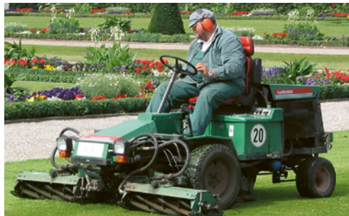
1 Le siège des tondeuses autoportées est réglable en hauteur et en fonction du poids de l'utilisateur.
