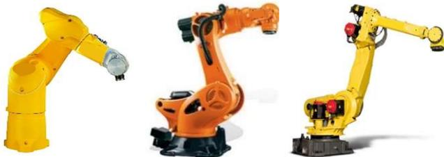
Die EN ISO 10218-1 legt Anforderungen und Anleitungen für die inhärent sichere Konstruktion, für Schutzmassnahmen und die Benutzerinformation für Industrieroboter fest. Sie beschreibt grundlegende Gefährdungen in Verbindung mit Robotern und definiert Massnahmen, um die mit diesen Gefährdungen verbundenen Risiken zu beseitigen oder hinreichend zu mindern.
