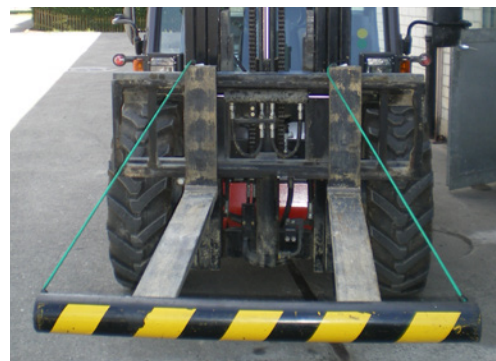
4 Lors des déplacements sur la voie publique, la fourche du chariot élévateur doit être recouverte d'un protecteur muni d'un ruban de signalisation adhésif.
