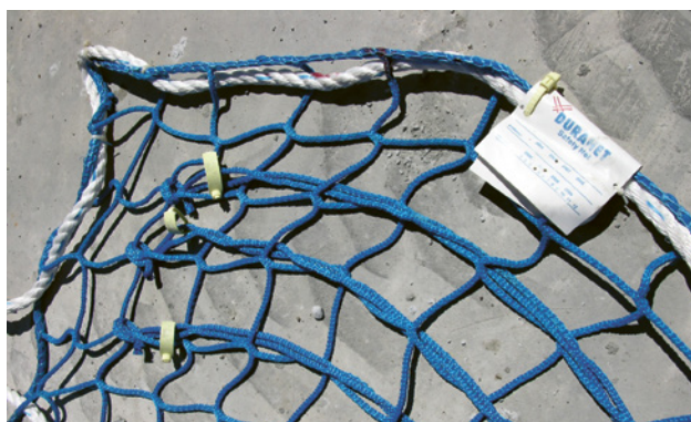
1 Fils de contrôle utilisés pour les essais annuels requis.
