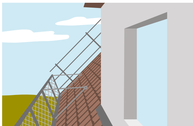
5 Paroi de retenue sur le toit inappropriée pour les travaux sur les lucarnes
