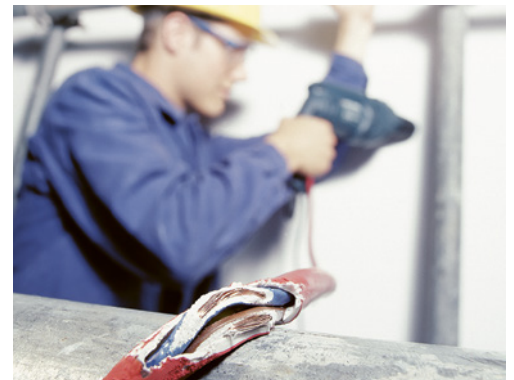
7 Stecker, Kabel und Elektrohandwerkzeuge vor Gebrauch auf Schäden kontrollieren.
