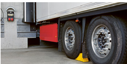
1 An der Ladebucht mit Radkeil gesichertes Fahrzeug
