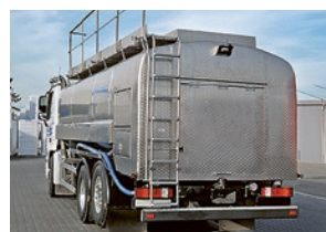
3 Fester Aufstieg an einem Lastwagen mit Klappgeländer
