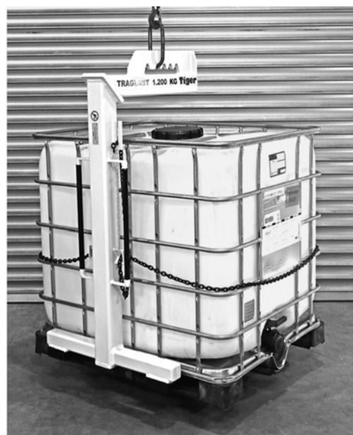
3 Forca per gru con catena di sicurezza per l'uso sui cantieri
