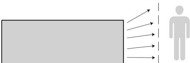
Bild 2 Der arbeitsplatzbezogene Emissionswert informiert über die Lärmabstrahlung am Arbeitsplatz.
