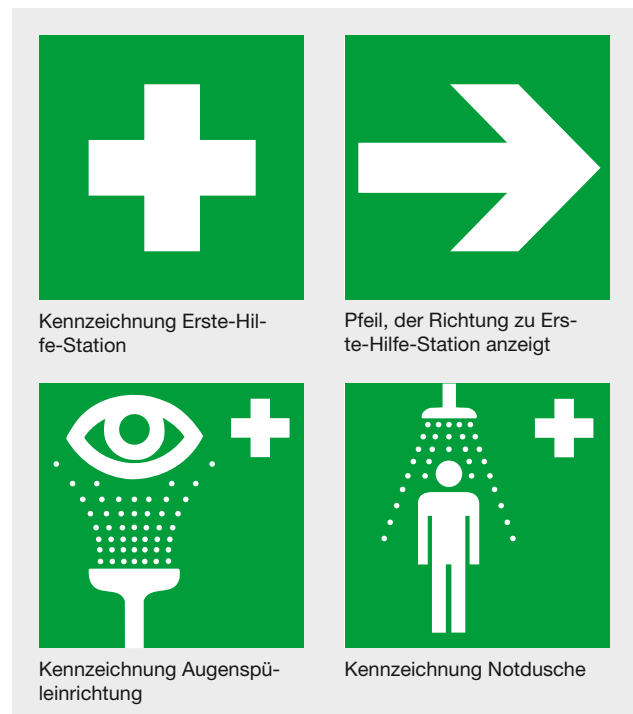
Bild 13 Zeichen für Hilfeleistungsstation und Rettungseinrichtung (grün)
