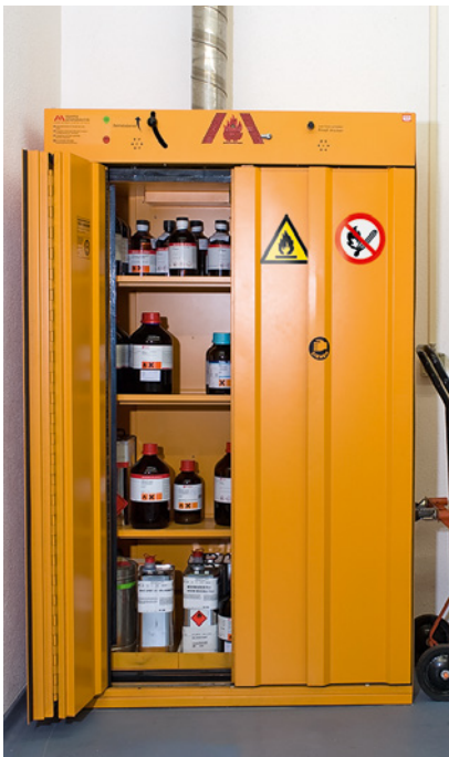
Bild 16 Verbotsschilder «Feuer, offenes Licht und Rauchen verboten» an einem Schrank, in dem feuergefährliche Stoffe aufbewahrt werden
