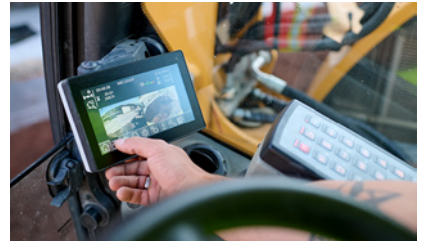
3 Baumaschine mit Rückfahrkamera
