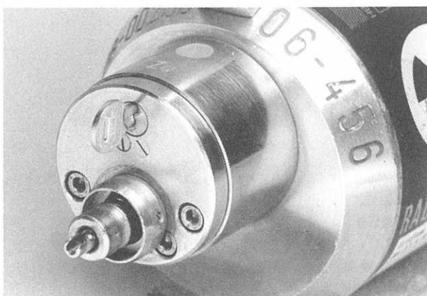
Figure 3 Serrure et clé, système de verrouillage
