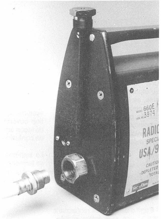
Figure 8 Pièces de raccordement de la gaine d'éjection
