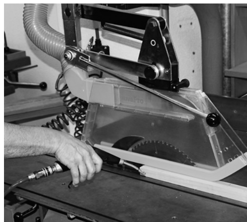
5 Réduction du bruit et protection contre la pénétration d'air comprimé dans le corps grâce à une conception adéquate de la buse. La figure présente une buse à canaux multiples peu bruyante.
