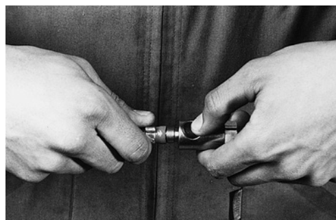
4 Raccord de sécurité. Lorsqu'on débranche, il n'y a plus de pression dans le raccord, ce qui évite tout rejet de tuyau.
