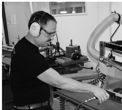
6 Pour prévenir de graves blessures oculaires et des troubles de l'ouïe, mieux vaut porter des lunettes de protection et des protecteurs d'ouïe.
