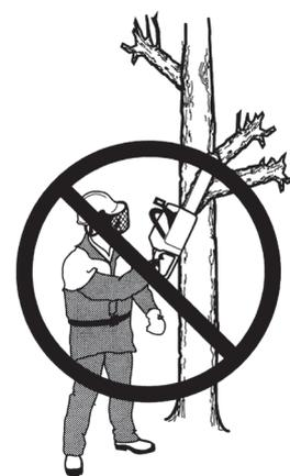
Ne pas effectuer de travaux à la tronçonneuse au-dessus du niveau des épaules. La tronçonneuse ne doit jamais être tenue et utilisée avec une seule main.
