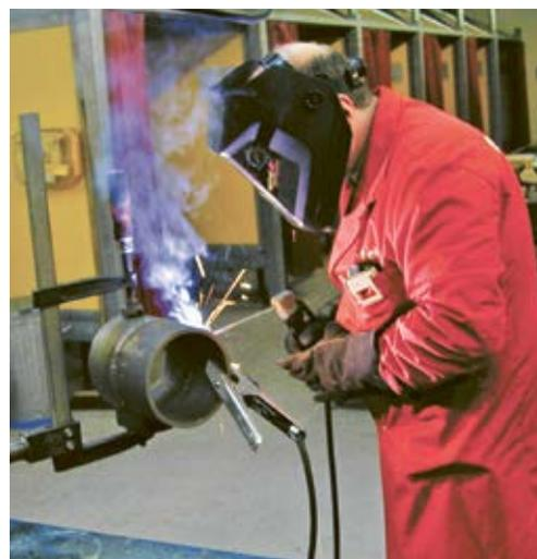
1 Avant de commencer à travailler, le soudeur doit s'assurer que le connecteur de retour de courant de soudage est branché correctement.
