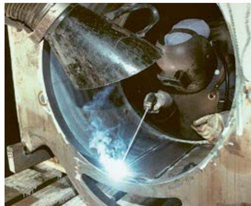
4 Dispositif flexible en forme d'entonnoir pour recueillir et aspirer les fumées de soudage.
