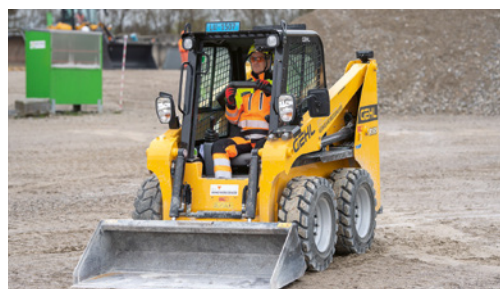
5 Pelle mécanique équipée d'une ceinture de sécurité et d'une structure de protection au retournement (ROPS/TOPS)
