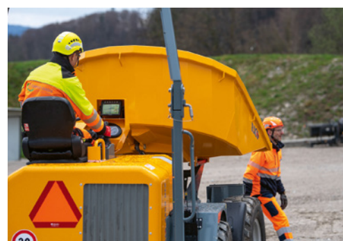
9 Un moyen technique (caméra) installé sur l'engin de chantier permet d'identifier à temps la personne présente dans la zone de travail.
