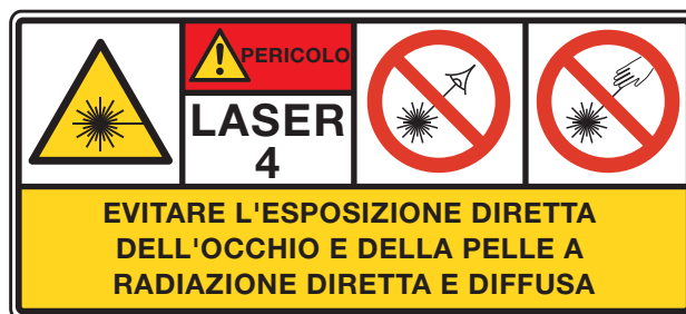
Figura 13: etichettatura dei laser di classe 4. In alternativa, si può usare l'etichettatura definita nel capitolo 6.2.
