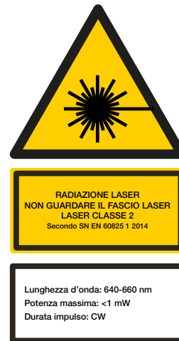
Figura 17: etichettatura dei laser di classe 2
