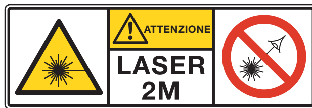
Figura 10: etichettatura dei laser di classe 2M. In alternativa, si può usare l'etichettatura definita nel capitolo 6.2.
