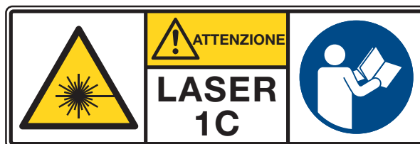
Figura 7: etichettatura dei laser di classe 1C. In alternativa, si può usare la stessa modalità di etichettatura del capitolo 6.2.
