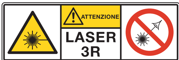
Figura 11: etichettatura dei laser di classe 3R. In alternativa, si può usare l'etichettatura definita nel capitolo 6.2.
