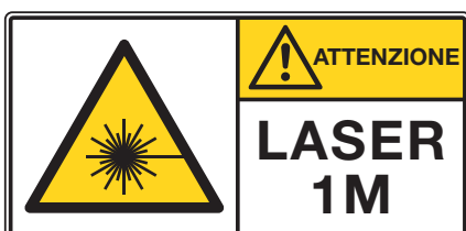
Figura 6: etichettatura dei laser di classe 1M. In alternativa, si può usare l'etichettatura descritta nel capitolo 6.2.
