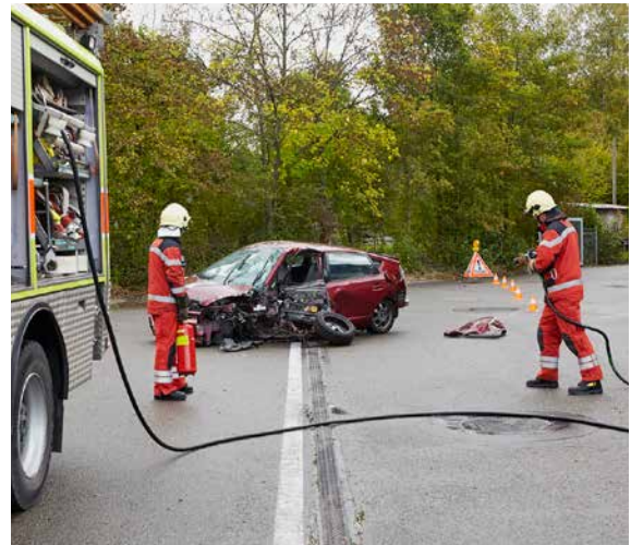
I veicoli incidentati dotati di sistemi ad alta tensione comportano diversi rischi, ad es. archi elettrici, pericolo d'incendio provocato dalla fuoriuscita di liquidi infiammabili e intossicazioni causate dall'inalazione di sostanze tossiche.
