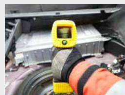
Controllare lo stato meccanico della batteria ad alta tensione e rilevare formazioni di calore con la telecamera termica.
