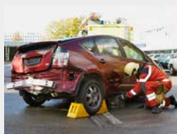
Immobilizzare il veicolo utilizzando le calzaioie.
