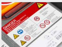
Esempio di adesivo di avvertimento su una fonte di energia ad alta tensione
