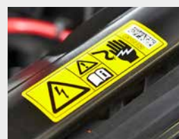
Segnali di avvertimento su componenti ad alta tensione
