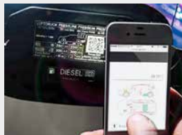
Diversi veicoli sono identificati da codici QR specifici, che consentono di accedere direttamente alle schede di soccorso.
