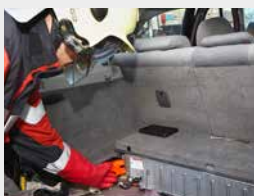
Disinserire la tensione (se possibile in conformità alla istruzioni del fabbricante o alla scheda di soccorso), ad es. rimuovendo il sezionatore di alta tensione dalla batteria.
