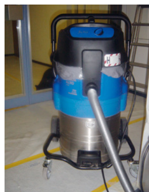
2 Aspirapolvere per amianto di classe H (secondo norma SN EN 60335-2-69)
