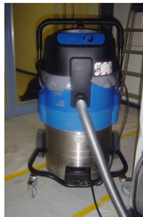
1 Aspirapolvere di classe H conforme alla norma EN 60335-2-69 con requisito speciale per l'amianto
