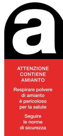
2 Etichetta adesiva «Attenzione contiene amianto»
