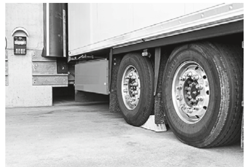
7 Veicolo su una rampa con le ruote bloccate da cunei
