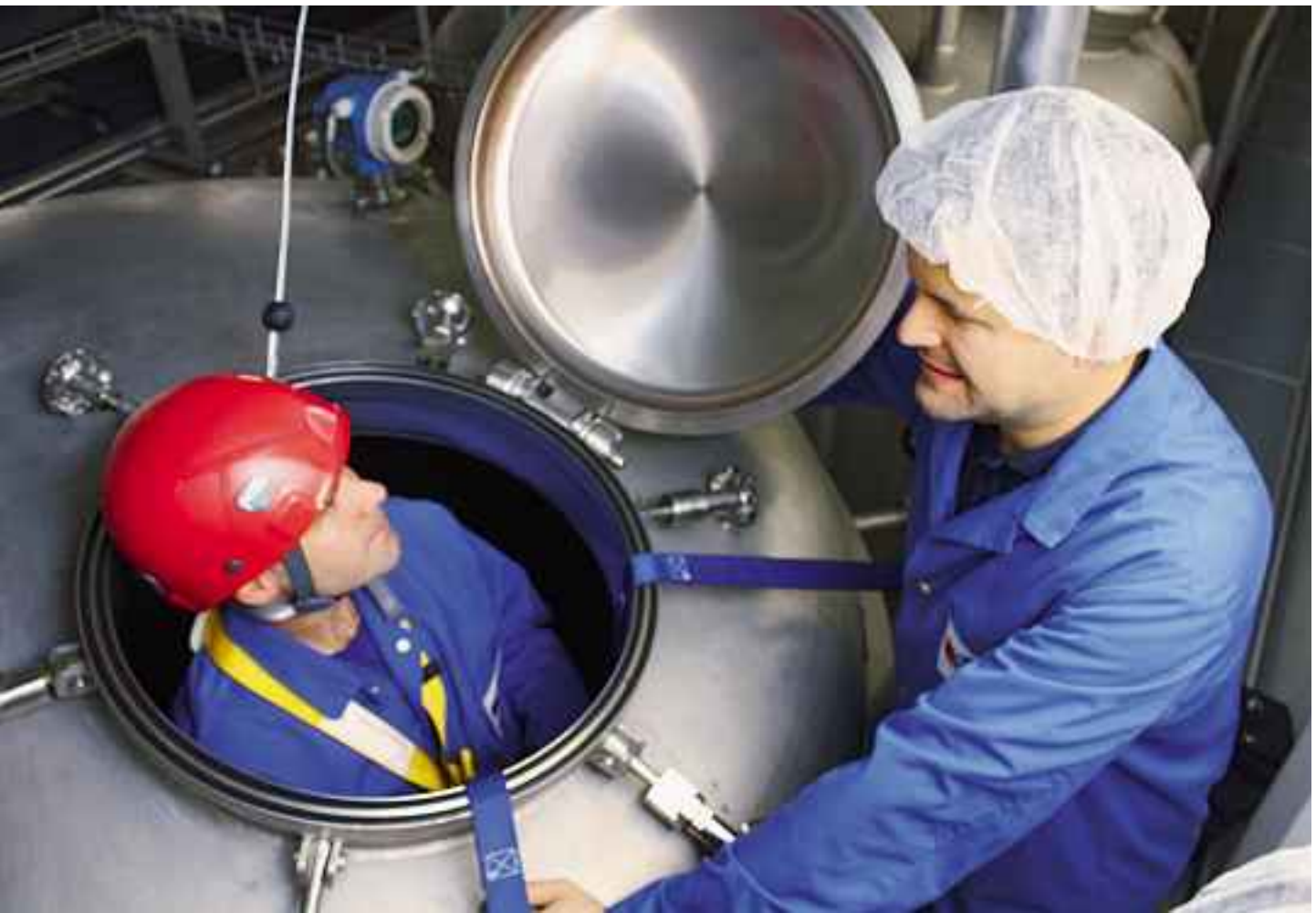
Instandhaltungsarbeiten in Tanks oder Silos nur zu zweit ausführen und geeignete Schutzausrüstung einsetzen.
