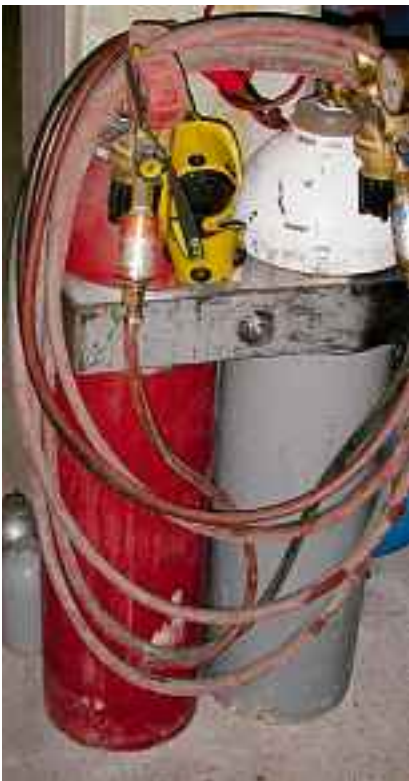
Bild 7: Acetylen und Sauerstoff: die Bestandteile des Autogenschweissens.
