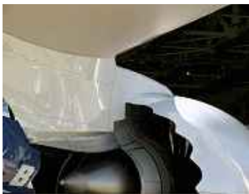
Geringere Lärmbelastung durch Zickzackleisten an den Triebwerkskanälen (Boeing 787)
