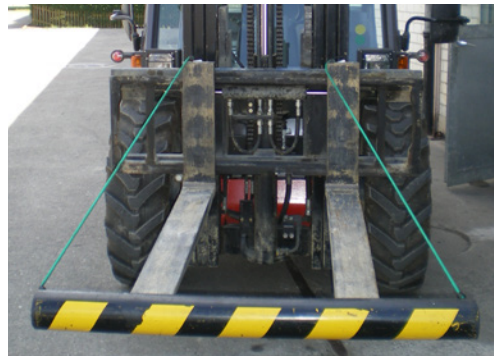
4 Markierte und abgedeckte Gabel an einem Stapler für Fahrten auf der Strasse
