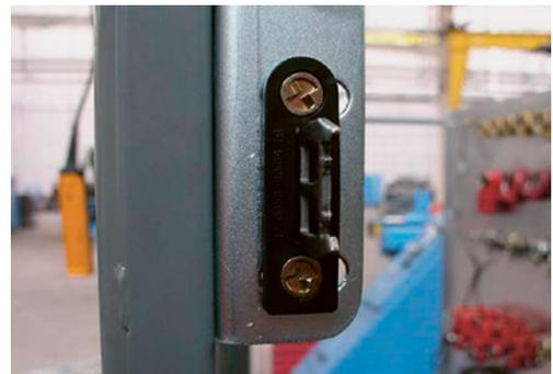
4 Empêcher un mauvais usage, p. ex. en fixant l'actionneur de l'interrupteur de sécurité par soudage, rivetage ou avec des vis non dévissables (fig.), en perçant ou en colmatant les têtes de vis ou en les bouchant avec des billes d'acier.
