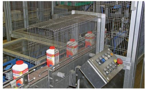
1 Un tunnel empêche l'accès d'une partie du corps à la zone dangereuse (distance au point dangereux  $\geq 850$  mm).
